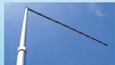
4.検尺棒を垂直に立て、高さ3.8mの車両限界を計測する。
