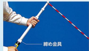
3.一段ごとに締め金具を緩めて止まるまで伸ばし、再び金具を締めて固定する。
