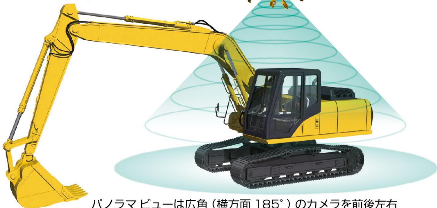
パノラマビューは広角（横方面 185°）のカメラを前後左右4箇所に取り付けて、自身の操作する重機・車両を真上から見るような映像をモニターに表示する装置です。バックモニター装置のような後進時の後方確認だけでなく、重機や車両の死角をなくす事で、全周囲を常に確認して安全な作業を補助します。\*オプションでドライブレコーダー併用可能です。（別途説明書あり）
